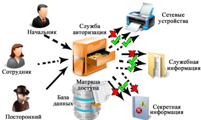
Рисунок 1 – Схема реализации дискреционного управления доступом
